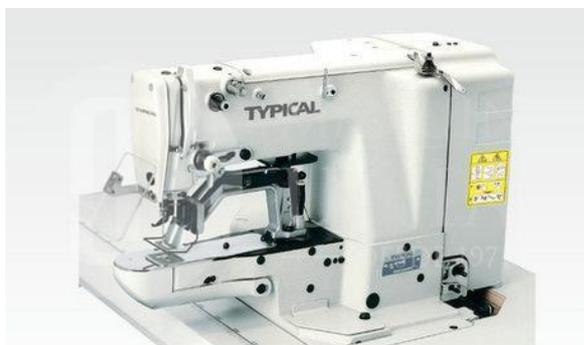
A máquina travete é uma máquina grande e de uso exclusivo para criação de travas em pontos onde há mais tensão, como bolsos, laterais e zíper, aumentando a resistência da peça e evitando que elas venham a descosturar com o tempo de uso. Entre as principais peças que a travete é utilizada estão: Calças, saias, bermudas e jaquetas jeans, biquínis, uniformes operacionais, bolsas e mochilas, etc.
